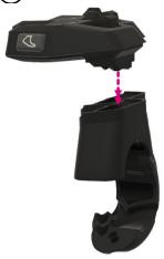
S Revisser le remote sur le support avec les nouvelles vis (M3x10) (0,5Nm).
