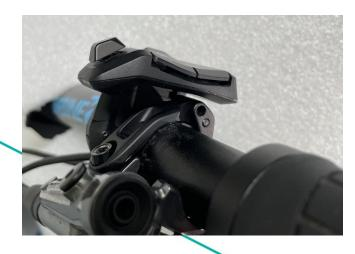
Sur certains freins, le collier de serrage des freins peut entrer en collision avec la face inférieure du Remote Basic si le frein doit être appliqué de manière plus raide. Pour éviter cela, nous avons créé une pièce d'écartement qui augmente la distance et permet ainsi un espace libre pour un réglage individuel du frein :
